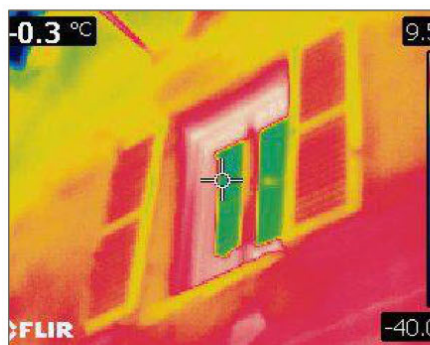
Plus l'image est rouge, plus la déperdition de chaleur est importante. Elle s'échappe principalement par les toits, les fenêtres, les balcons, planchers et équipement (ventilation, etc). Le centre-ville de Brignoles, visé par une politique de réhabilitation, comprend de très nombreuses résidences mal isolées.
