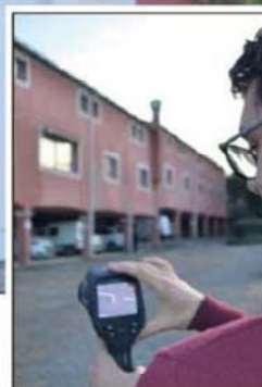
À l'aide de sa caméra thermique, Samuel Vaillant va déceler les déperditions d'énergie, coûteuses aussi bien pour l'environnement que le porte-monnaie. (Photos C.D.)
