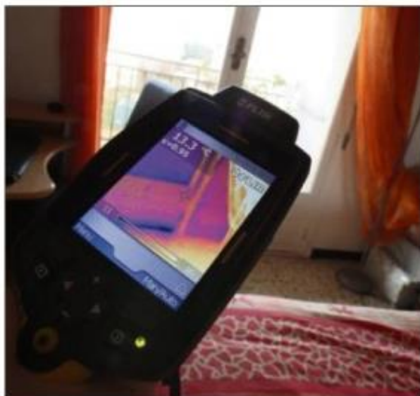
Intérieure ou extérieure, la thermographie s'effectue au moyen d'un imageur thermique qui permet de détecter les déperditions de chaleur des habitations. (Photo doc V.-m.)
