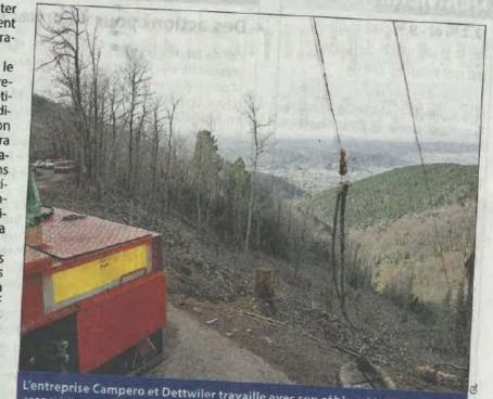
L'entreprise Campero et Dettwiler travaille avec son câble mât sur remorque, associé à une pelle à pneu munie d'une tête d'ébranchage.
